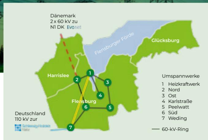
← Vorausschauend geplant: Eine neue Doppeltrasse soll unser Heizkraftwerk mit dem Umspannwerk in Weding verbinden.
