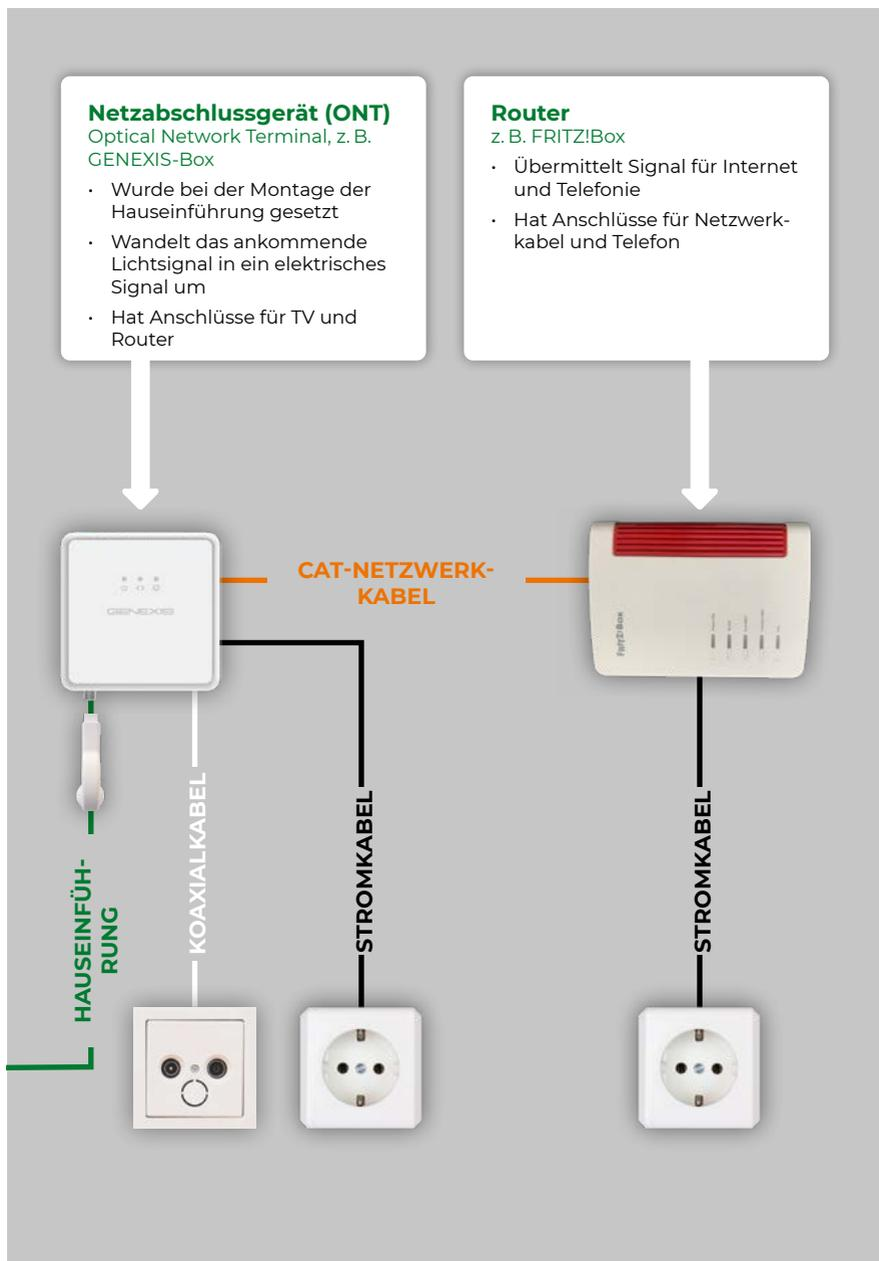
Zum blitzschnellen Surfen ist es jetzt nur noch ein kleiner Schritt. Nach Montage des Netzabschlussgeräts durch uns verbinden Sie es nur noch mit dem Router und versorgen beide mit Strom. Der Router wird Ihnen rechtzeitig und automatisch vor Ihrer Schaltung zugeschickt. Er ist bereits mit all Ihren Daten vorkonfiguriert, sodass Sie direkt lossurfen können. Als letzten Schritt schließen Sie Ihre Endgeräte (z. B. Notebook und Telefon) an.
